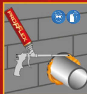
Прокладка труб, кондиционных путей, вытяжек
